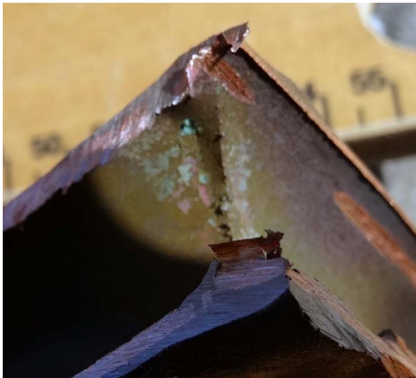
Bild 110 Gropfrätning vid lödning
