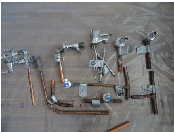
Bild 105 Provbitar från rörsystemet i badrum 2AA1
